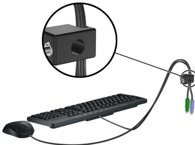
Obrázek C-4 Protážení kabelů klávesnice a myši
